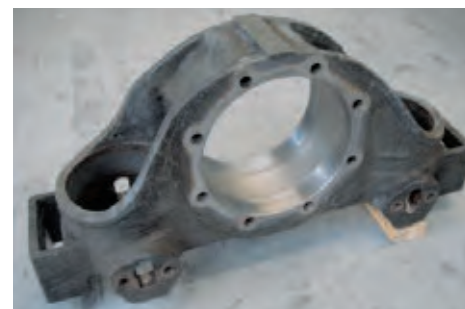
Achslagergehäuse Lagerbohrung veralisiert D 214x70 Schicht 1,4 mm
