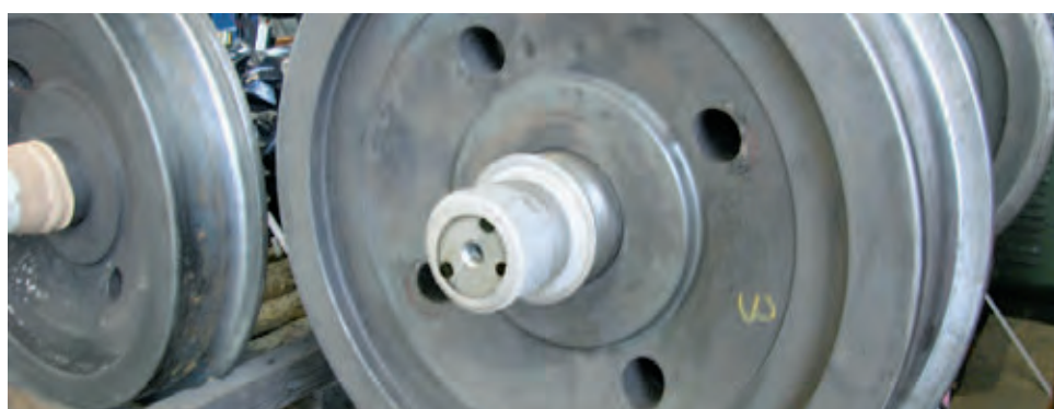
Radsatz Lagersitze D 120x16 und D 95x70 Schicht 2 mm veralitiert
