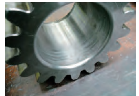
Abb. 1a: Ritzel mit Abrasion/Adhäsion
