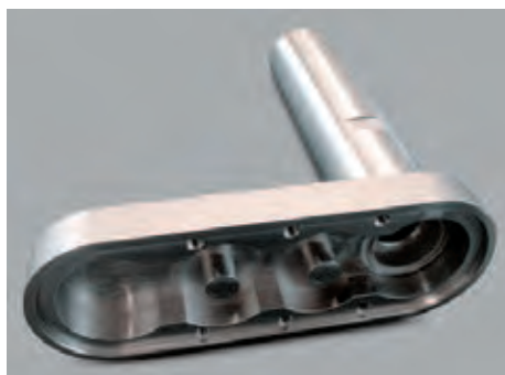
Schwenkarm Bohrung veralnisert D 28x9lg Schicht 0,5 mm
