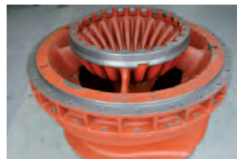
Lufteintrittsgehäuse Bohrung veralisiert D 125x47 Schicht 0,5 mm
