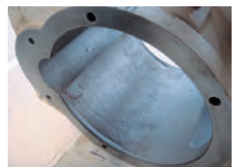
Abb. 1b: Vakuum-Pumpengehäuse mit Erosionsverschleiss
