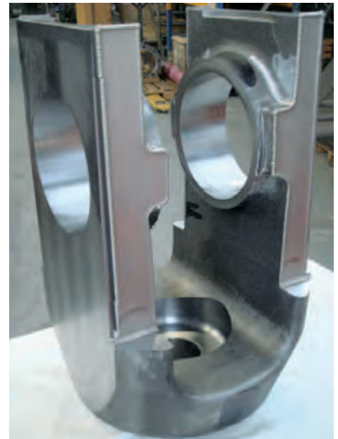
Kreuzkopfkörper 2 Flächen veralnisert 45x326 Schicht 1,2 mm
